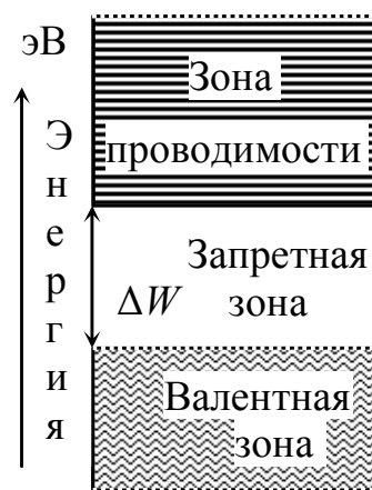
Рисунок 1.4 – Запретная зона на энергетической диаграмме полупроводников и диэлектриков
