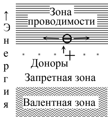
Рисунок 5.5 – Энергетическая диаграмма примесного полупроводника n -типа
